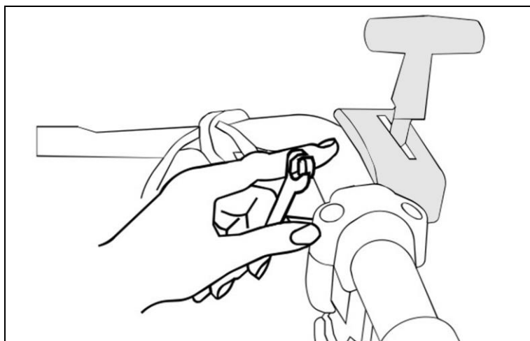
Рис. 6. Фиксация рычага газа на рукоятке
