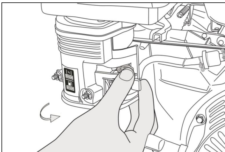
Рис.14. Воздушная заслонка закрыта
