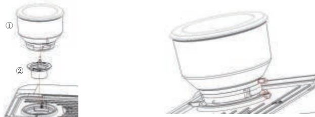
Рисунок 1: Установите режущую головку 2 и затяните Рисунок 2: выравнивайте положение режущей головки красным кружком, затем нажмите режущую головку
