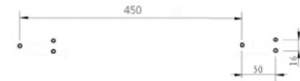
монтажное отверстие для 2000 Вт и 2200 Вт
