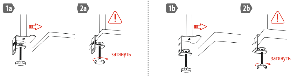
Рисунок 3. Установка кронштейна. Вариант «а» для столешниц до 20 мм, вариант «б» для столешниц до 50мм
