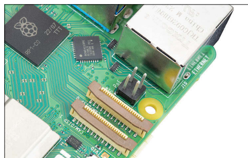
Рис. 1-9. Разъем PoE на Raspberry Pi для питания через интерфейс Ethernet
