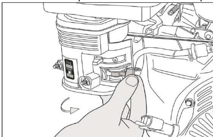
Рис. 22. Открытие топливного крана
