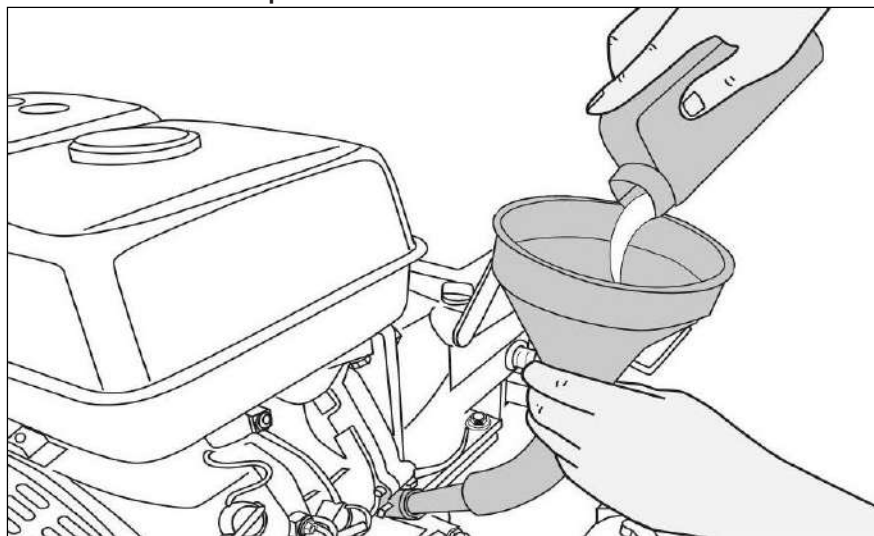
Рис. 16. Заливка масла в двигатель
