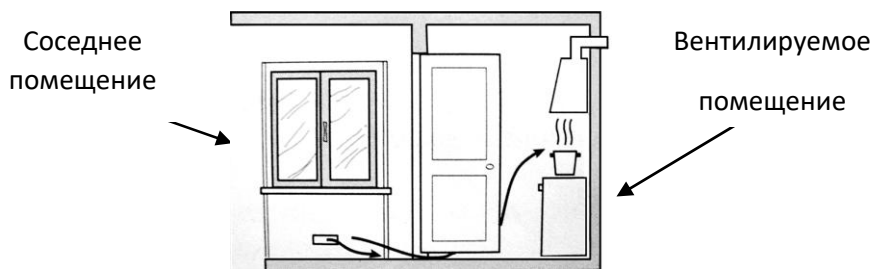
Рис. В Косвенный приток воздуха с увеличением вентиляционной щели между окном и полом
